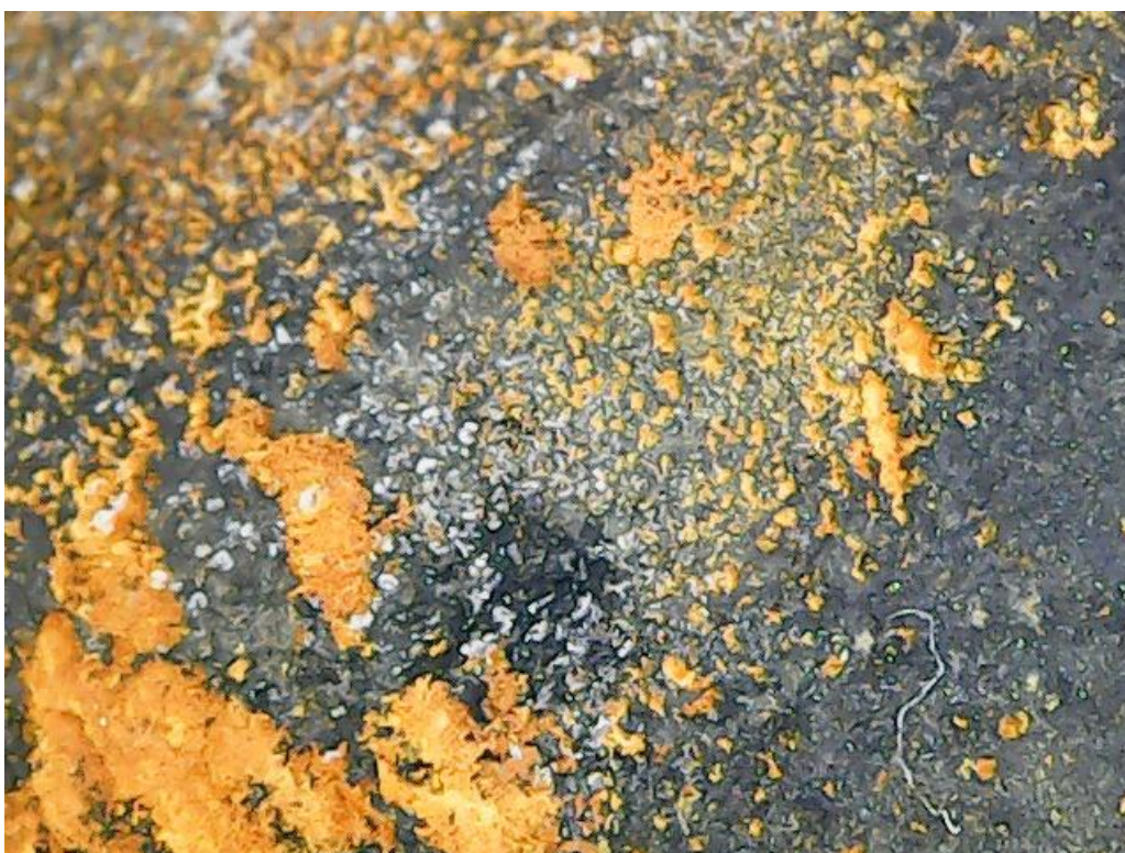
Сурет 32– Ащысай кен орнының жабындысыз жер асты жағдайларында айдау бөлігінің мұнай кәсіпшілігі құбырының коррозиясы (10 ай)
