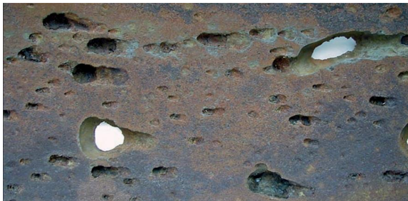
Сурет 3 - Құбырдың (D 426 = 8 мм) МЖЖ төменгі жағында түзілген ойық жаралы коррозиясы [11, 114 б.]
