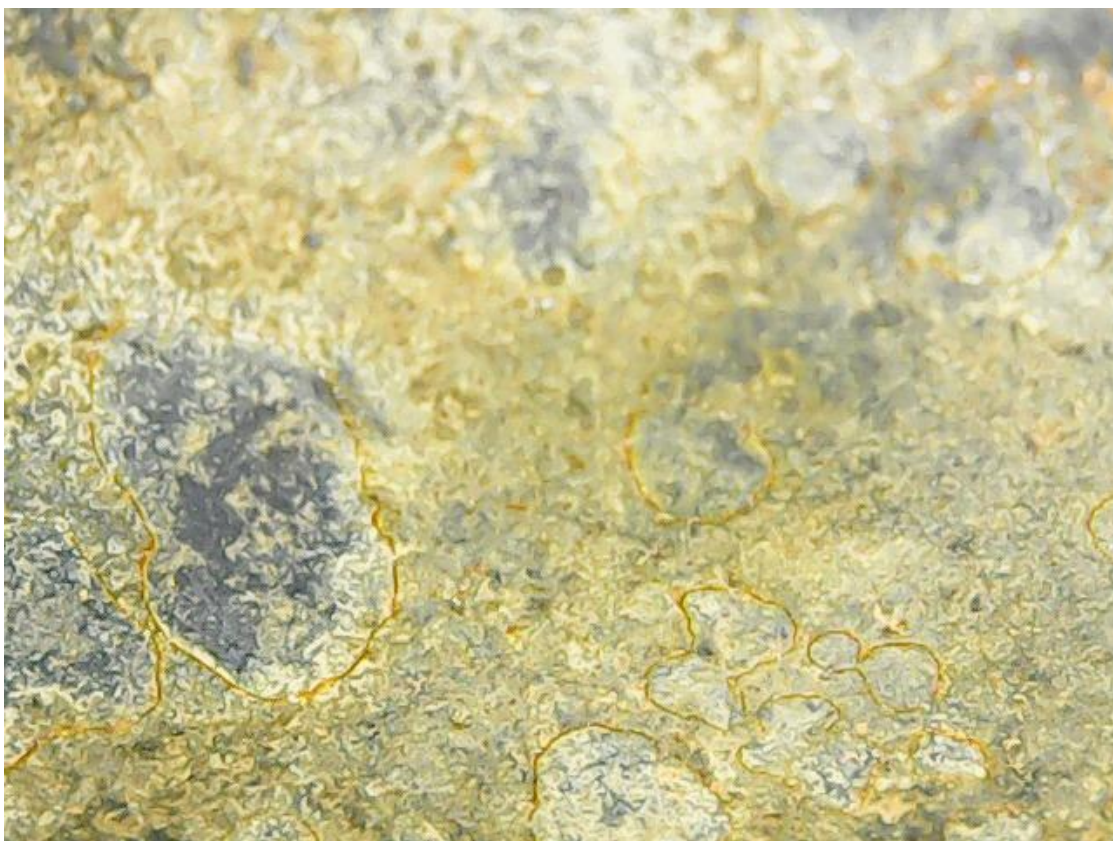
Сурет 31 – Ащысай кен орнының атмосфералық жағдайында жабындысыз айдау бөлігінің мұнай кәсіпшілігі құбырының коррозиясы (6 ай)
