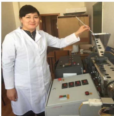
Сурет 19 – Экструдерде композиция алу.
