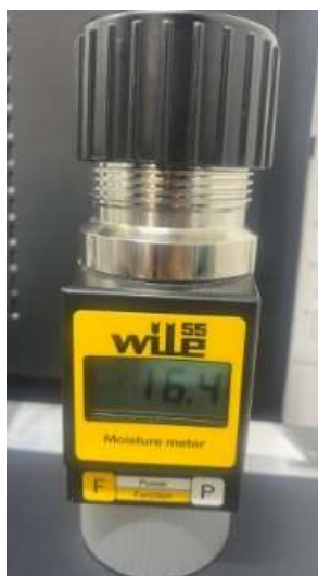
Рисунок 39 - Измерение влажности орехов влагомером Wile 55
