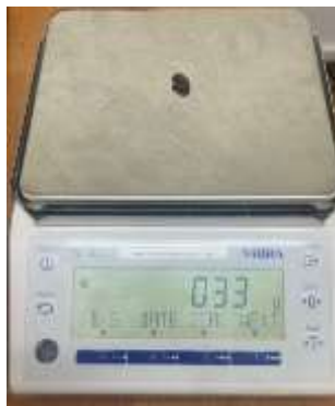
Рисунок 38 – Измерение массы орехов (весы Vibra ALE-6202R)
