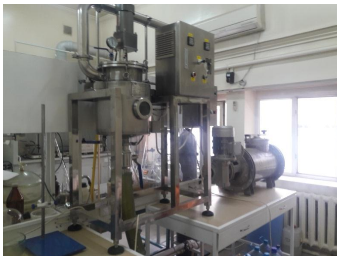
Сурет 49 - Литий хлоридін экстракциялауға арналған үлкейтілген-зертханалық қондырғы
