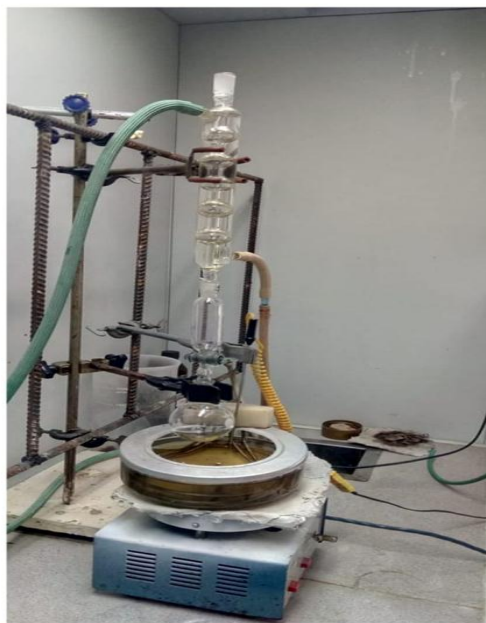
Сурет 32- Литий хлоридін экстракциялау үшін зертханалық қондырғы
