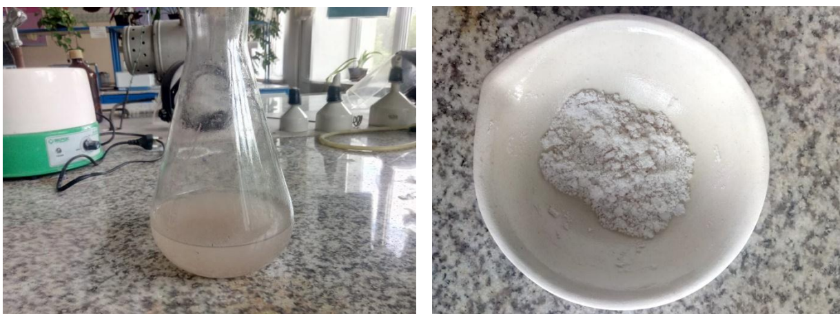
Сурет 36- Бутил спиртімен тұзды ерітінді экстракциясының ерітіндісі мен тұнбасы
